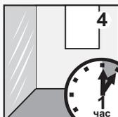
**4** Загрунтованную поверхность оберегайте от попадания пыли. Дальнейшие отделочные работы проводите через 1 час после нанесения последнего слоя грунта (при t +20°C).
