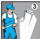
**3** Грунт готов к применению и не требует разбавления. Наносится на основание в один слой кистью, валиком или краскораспылителем. Сильно впитывающие поверхности необходимо грунтовать в два слоя с промежуточной сушкой в 1 час. Работы проводить при температуре воздуха и основания от +5°C до +35°C.
